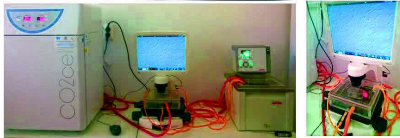
Mini-incubator pentru culturi celulare cu un sistem de bobine în interior (sus); sistemul de incubație realizat în laborator (jos)
