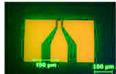
Imagina oscilatorului cu transfer de spin, obținută după definirea contactelor electrice în configurația "ground-signal-ground"
