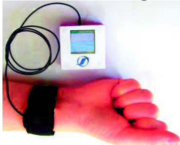
Dispozitiv pe bază de senzor magnetoelastic pentru monitorizarea și înregistrarea pulsului cardiac provenit de la arterele periferice
